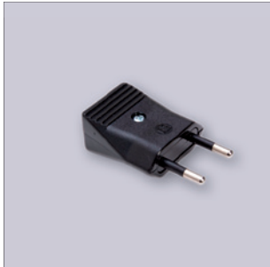
N° 623 Clavija bipolar sin t.t. 10 Amp. 250 V. Espiga preaislada ø 4 m/m. Color: BLANCO, NEGRO. Fabricado s/norma UNE 20315.94.
