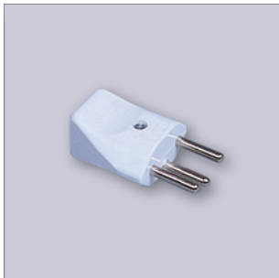
N° 521 Clavija con t.t. desplazada. Sistema suizo. Espárragos 4 m/m. ø 10 Amp. 250 V. Color: BLANCO, NEGRO. Material: Nylón.
