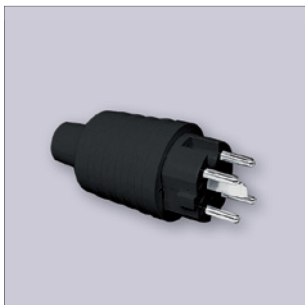
N° 2429.090 Clavija PERILEX 3 polos + N + \perp 16 Amp. 400/230 V. Color: NEGRO. Material: Goma. Fabricado s/norma DIN.49445.46 Protección IP44 \Delta
